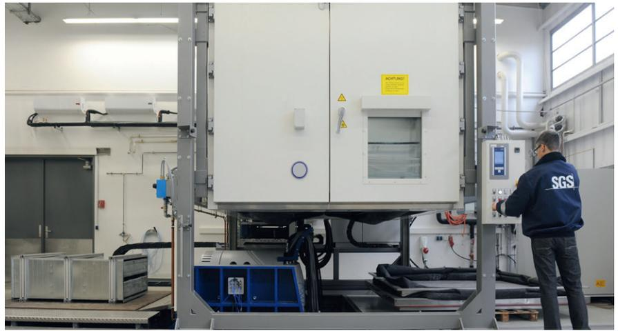
*Aufbau eines Vibrations- tests für Traktionsbatterien mit überlagerten Temperaturprofil und Bestromung (Quelle: SGS Battery Testhouse München)*
